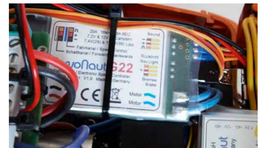
Dank seiner flachen Form passt der Fahrregler G22 ohne aufwändige Anpassarbeiten gut ins Fahrerhaus
