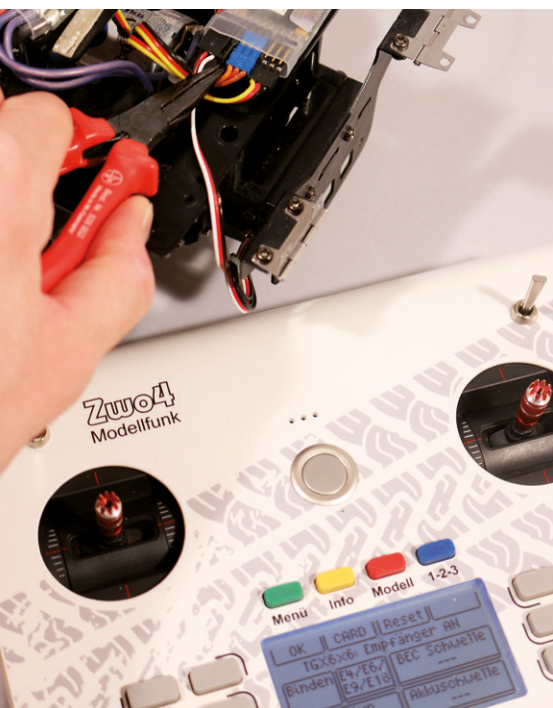
Der R+7 ergänzt den RX9 um sieben zusätzliche Kanäle. Er wird per Kabel angeschlossen, konfiguriert werden muss hier nichts
