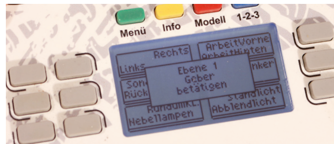
Im Gebermenü können die Taster und Knüppel eingestellt werden. Bei betätigtem Ebenenschalter wird der Geber für die jeweilige Ebene eingestellt ...
