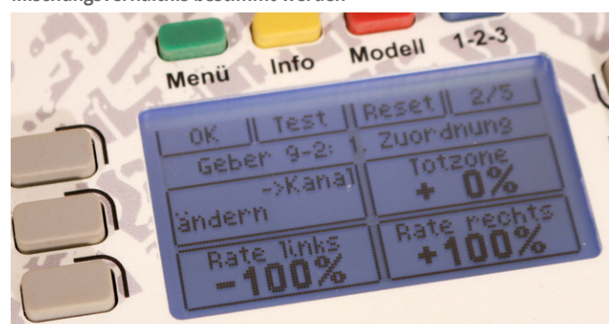
Im Gebermenü selber wird dann der Kanal ausgewählt, den dieser Geber bedienen soll. Beim HS16 können vier Kanäle (auf den Seiten 2 bis 5) ausgewählt und über die Rate deren Mischungsverhältnis bestimmt werden
